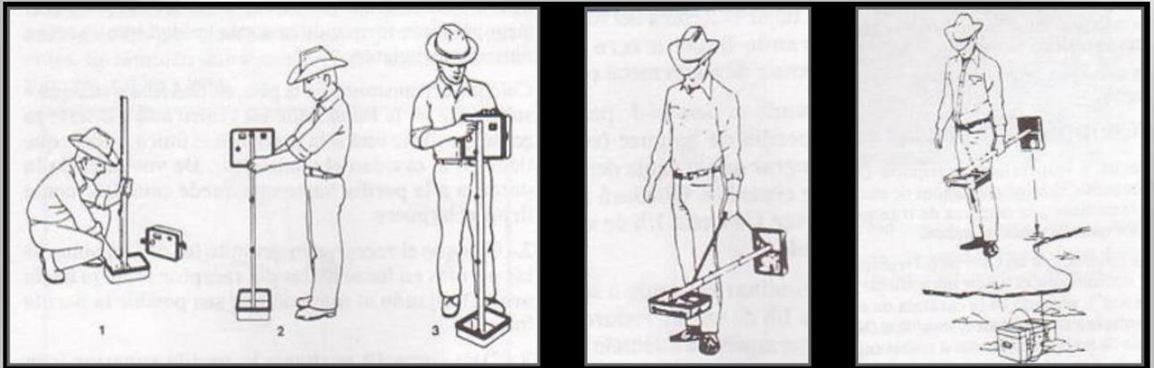
Procedimiento de armado del equipo.
